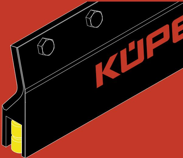
Der einvulkanisierte KÜPER-Schriftzug dient als exakt platzierte Abfahrmarkierung. Der entscheidende Vorteil dieser Methode besteht darin, dass die Abfahrmarkierung trotz widriger Wetterbedingungen wie Schnee oder Streumaterialien nicht abgelöst oder beschädigt wird. Die Leiste mit extrem langer Lebensdauer kann bis zur völligen Abnutzung der Korundelemente eingesetzt werden.
